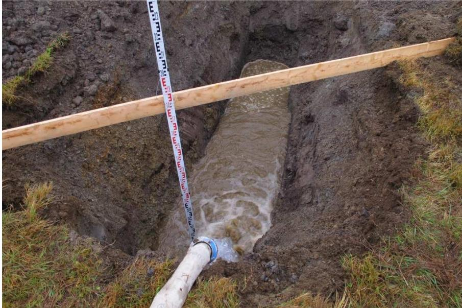
Abb. 4: Sickerversuch in Baggerschürfgrube S02/16 (Foto: GDP ZT GmbH)
