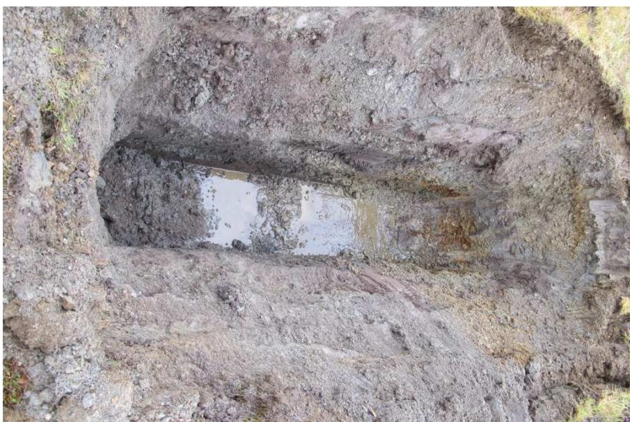
Abb.3: Baggerschürfgrube S02/16 - Aushubsohle auf -1,7 m (Foto: GDP ZT GmbH)
